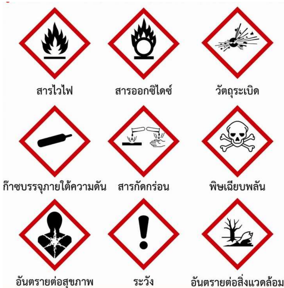
ภาพ: สัญลักษณ์แสดงความเป็นอันตรายของสารเคมี
