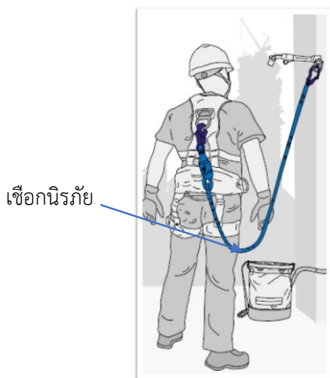
ภาพที่ 2-11 การใช้อุปกรณ์เชื่อมต่อ (เชือกนิรภัย)
